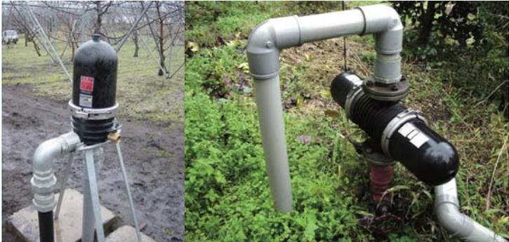
ディスクフィルターは溝の入ったディスクを積み重ね、積み重ねたディスクの溝によってろ過します。このため耐久性がとても高く、トラブルが少ないため安心して長く使えます。
