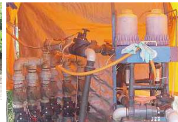
▲ドリップかん水と、比例式液肥混入器ドサトロンを使用した養液栽培は少ない肥料で高品質を可能にするシステムです。
