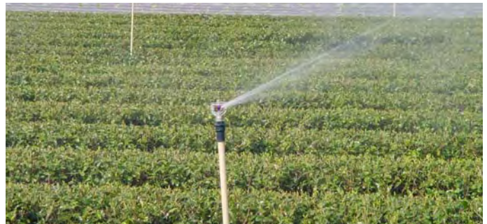
◀伸縮ライザーとR10Tスプリンクラーを使ったかん水と凍霜害防止に使えるシステムです。
